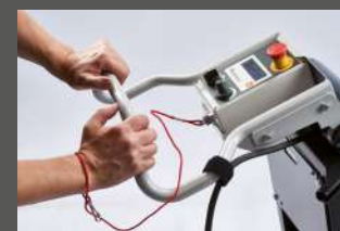
Выключатель мертвеца для безопасной работы
