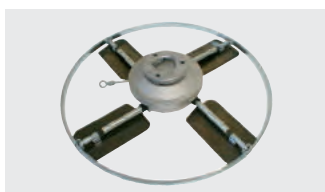
Заглаживание с помощью лопастей
