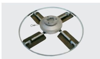
Заглаживание с помощью лопастей
