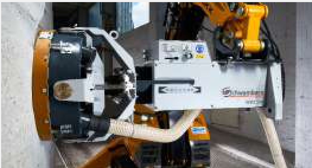
Карданный подвес шлифовальной головки всегда ровно прилегает даже при наклоне до 6%
