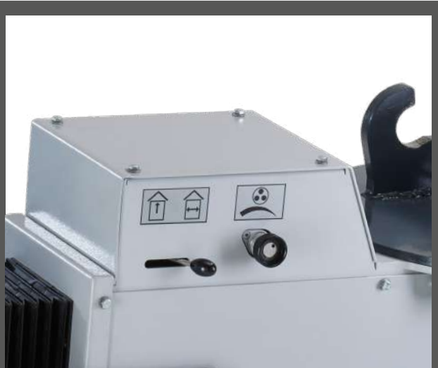
Переключение режимов стена – потолок | плавное изменение скорости вращения
